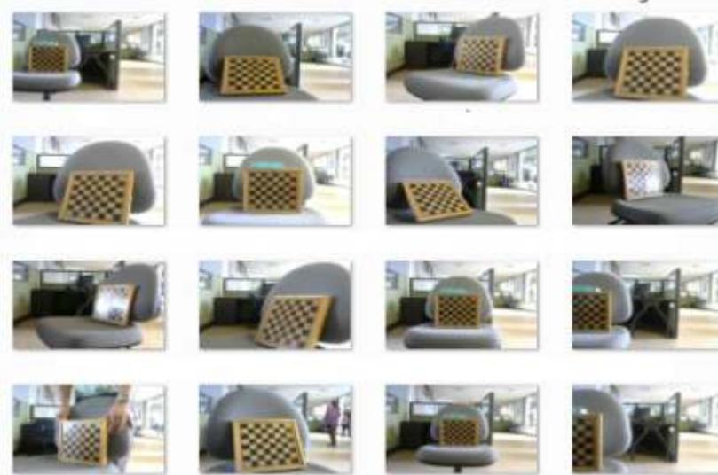
**Fig 3.** Imagen del Patrón Geométrico para calibración de la cámara desde diferentes perspectivas
